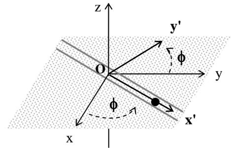
On peut donc exprimer  $\vec{\gamma}_a$  l'accélération absolue de  $M$  dans  $R$ , en fonction de  $\vec{\gamma}_r$  l'accélération relative de  $M$  dans  $R'$  de la manière suivante :  $\vec{\gamma}_a = \vec{\gamma}_r + \vec{\omega} \wedge (\vec{\omega} \wedge \vec{OM}) + 2\vec{\omega} \wedge \vec{v}_r$ , où  $\vec{v}_r$  est la vitesse relative de  $M$  dans  $R'$ .
