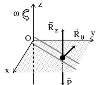
PFD : dans un repère galiléen et pour un système de masse constante il s'écrit :  $\sum \vec{F}_{\text{ext. au syst.}} = m_{\text{syst.}} \vec{\gamma}_{\text{syst.}}$
